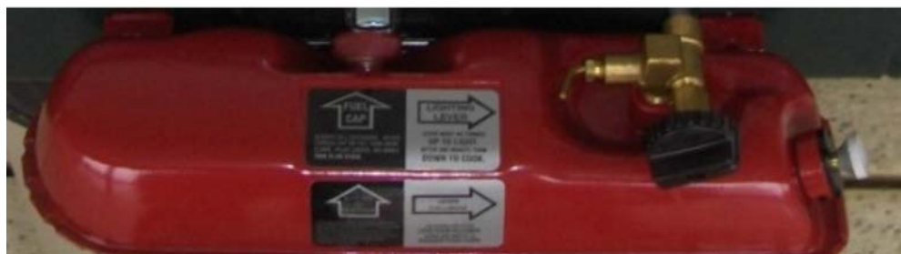
Figure 2 Réservoir de combustible
