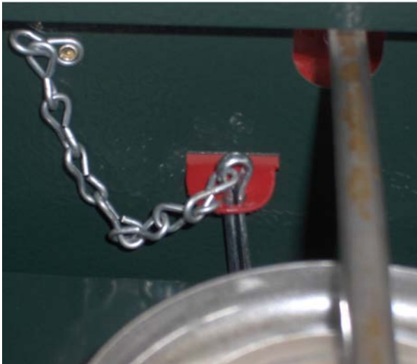
Figure 5 Fixer la chaîne de sécurité
