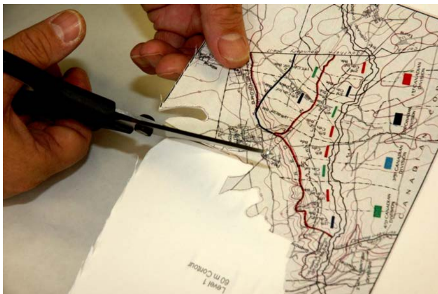
Figure A-5 Découpage du morceau du niveau 1 à partir du modèle
